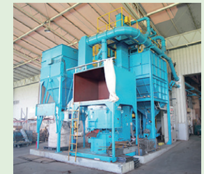
鋳造用砂のリサイクル用攪拌機
